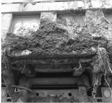
●Đất bám đầy thành xe từ khu vực mức đất đi ra đường dân sinh.
